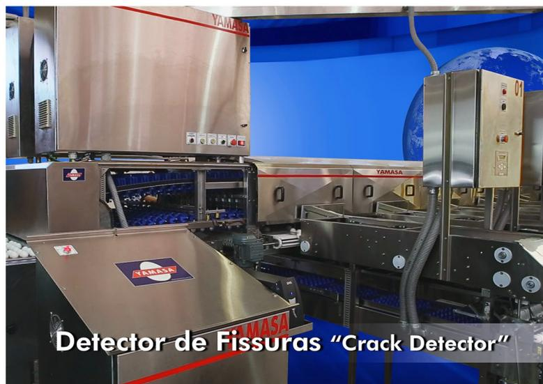
Detector de Fissuras "Crack Detector"
