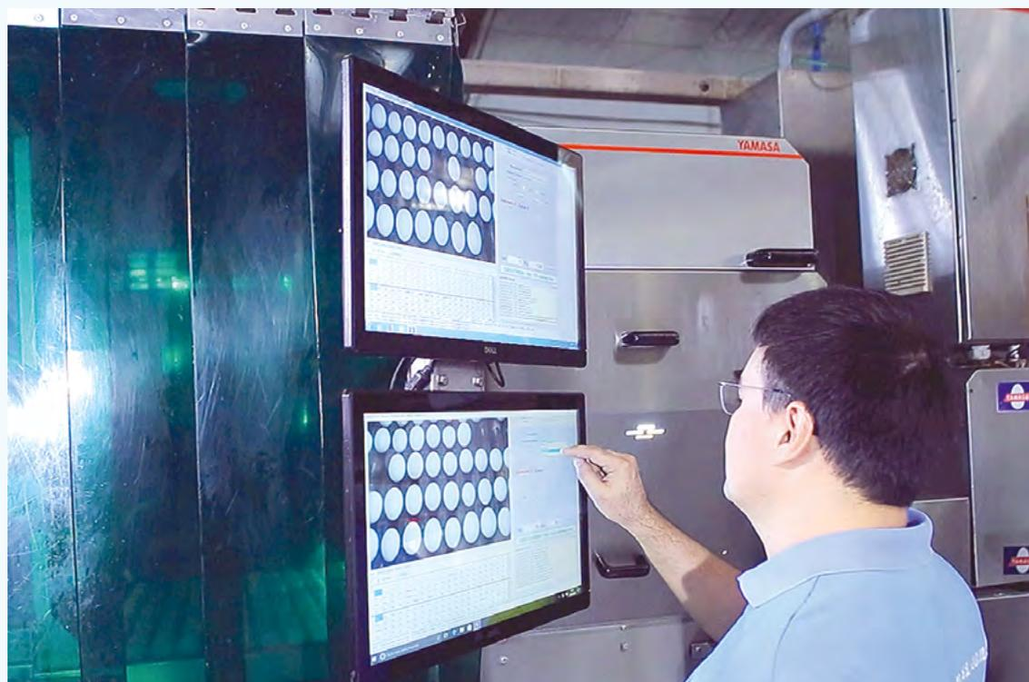
A Yamasa está lançando um novo sistema de ovoscopia automático totalmente controlado por multicâmeras e iluminação. Com o novo equipamento é possível detectar ovos sujos e vazando através do processamento de imagens pelo sistema de visão computacional. Cada ovo é inspecionado por câmeras e cada uma delas registra imagens do ovo enquanto ele está girando sobre os roletes da esteira transportadora.
