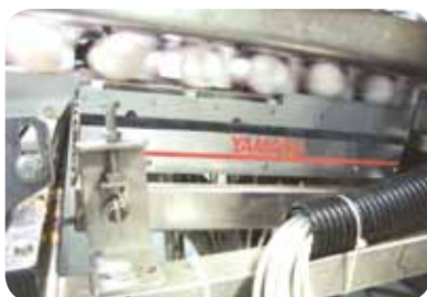
CRACK DETECTOR detecta fissuras ou trincas em ovos, permitindo à granja manter a qualidade
